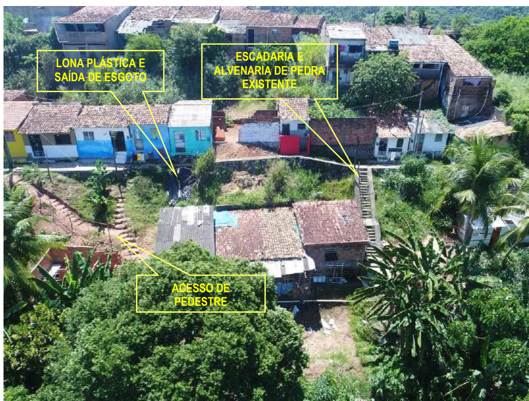
Figura 5.2.- Vista aérea frontal do talude, observa-se a presença de vegetação de grande porte, alvenaria de pedra existente a montante do talude e edificações próximas ao talude.
